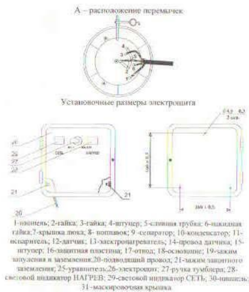
Рисунок 1- Аквадистиллятор электрический ДЭ-10 «СПБ»
